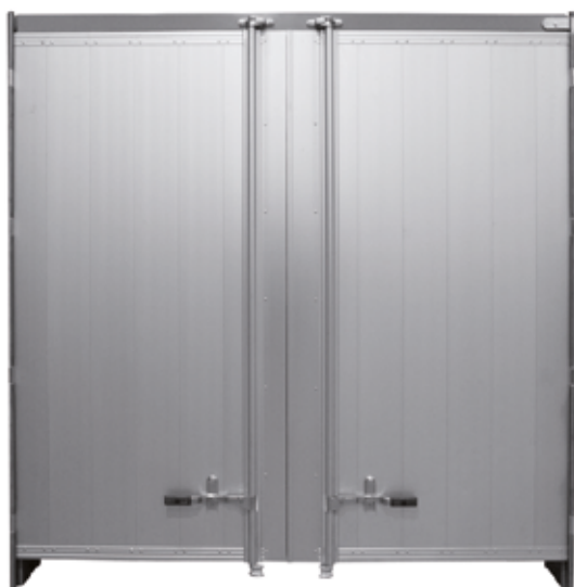
Puerta trasera con cierre exterior
